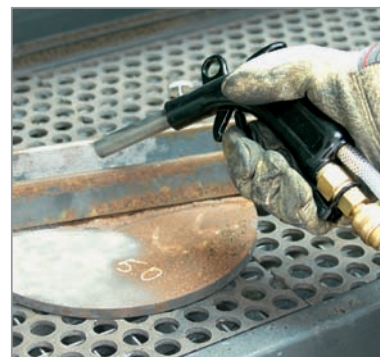
Chorro de arena, rápido y efectivo
